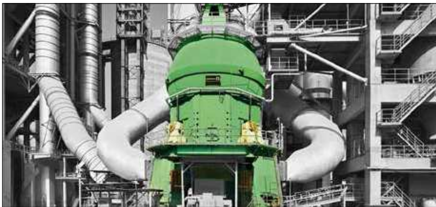
Die Wälzmühlen von Loesche kommen mit verschiedenen Rohstoffen wie Zement, Kohle oder Kalk erfolgreich zum Einsatz.
