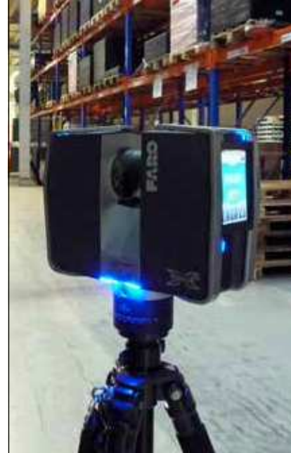
Der Faro Focus3D X 130 liefert ausführliche 3D-Punktwolken zur präzisen Dokumentation.
